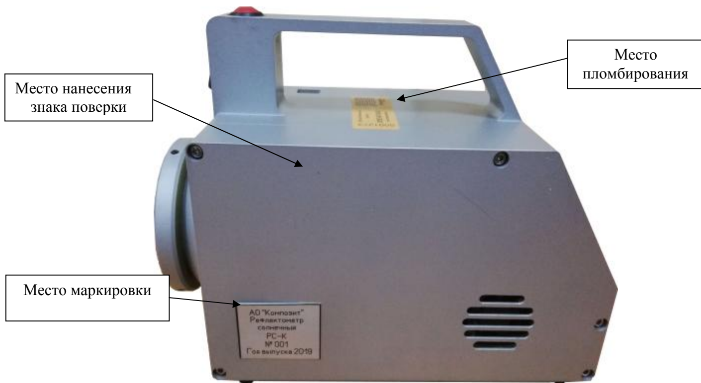
Рисунок 2 - Схема пломбировки от несанкционированного доступа, обозначение места нанесения знака поверки
