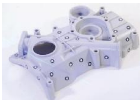
Рисунок 3 - Общий вид меток и пример их нанесения на объект сканирования
