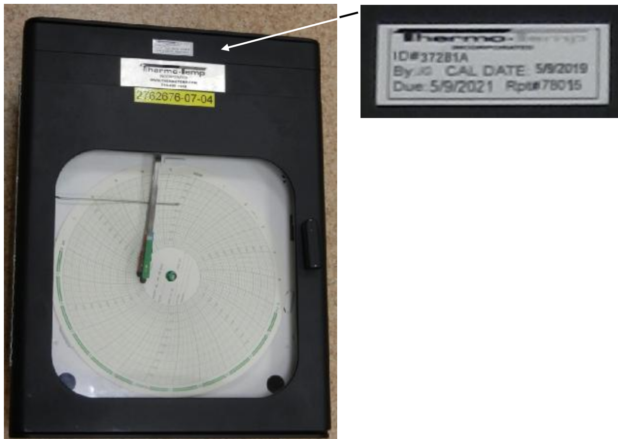
Рисунок 1 – Общий вид регистратора давления 242E
