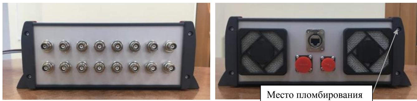
Рисунок 1 – Общий вид дефектоскопов и схема пломбировки от несанкционированного доступа
