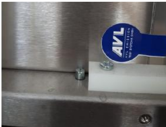
Рисунок 2 – Схема пломбирования корпуса газоанализатора
