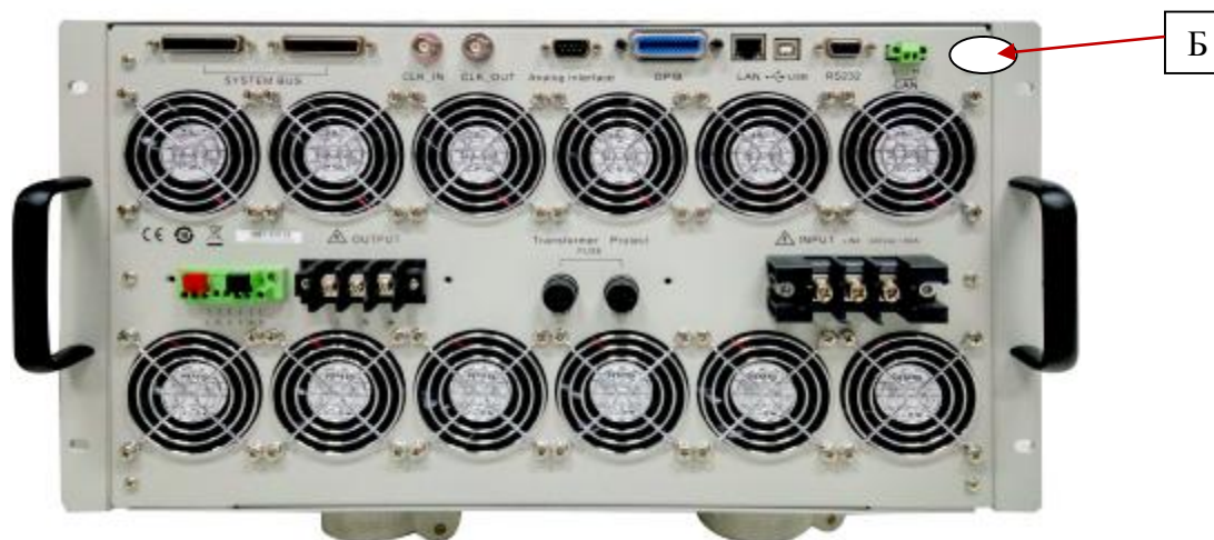
Рисунок 3 – Схема пломбировки от несанкционированного доступа (Б)
