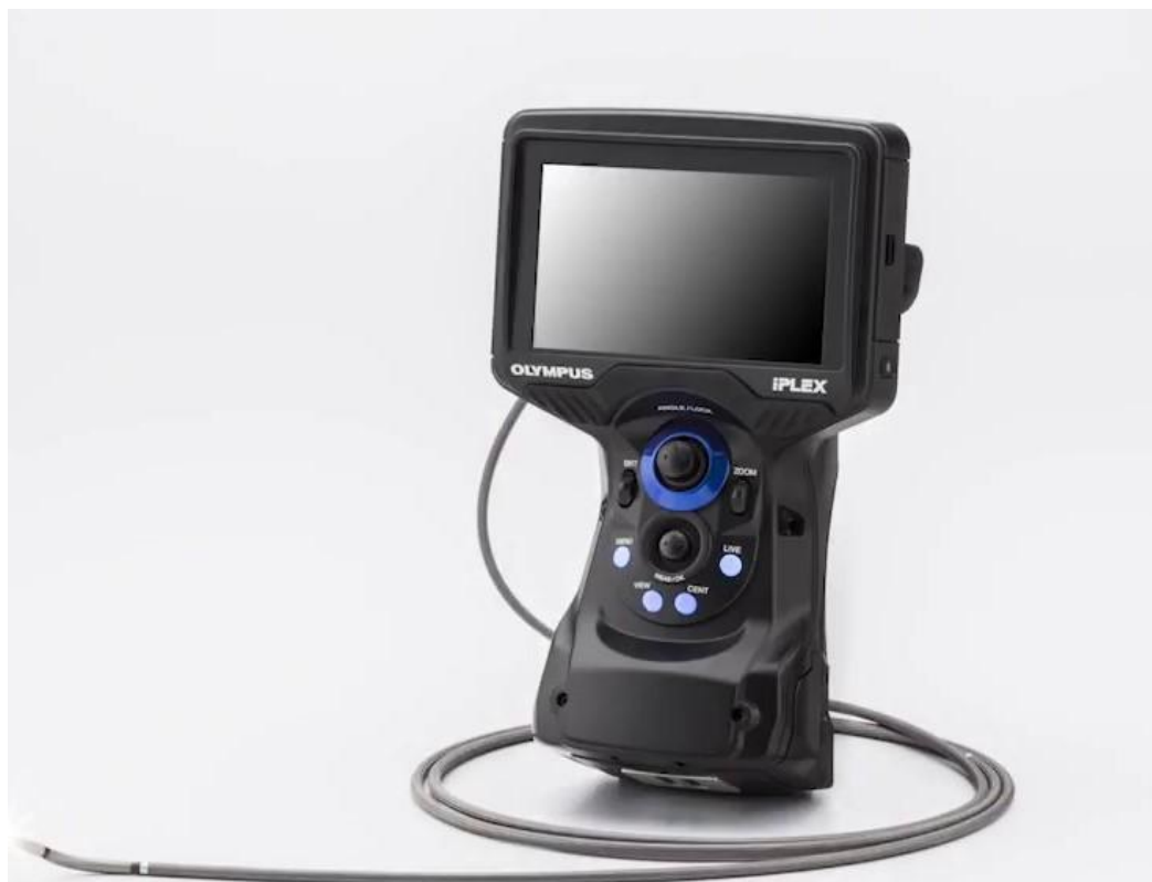
Рисунок 2 – Внешний вид видеоэндоскопов измерительных OLYMPUS IPLEX G Lite
