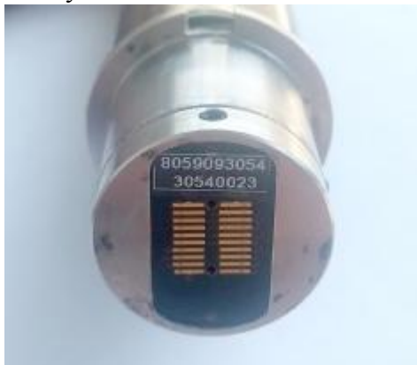
Рисунок 2 – Общий вид нижней части головки smartHEAD
