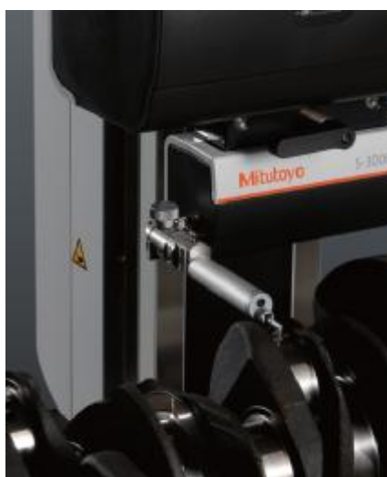
Рисунок 4 – Поворот щуповой системы на 90°
