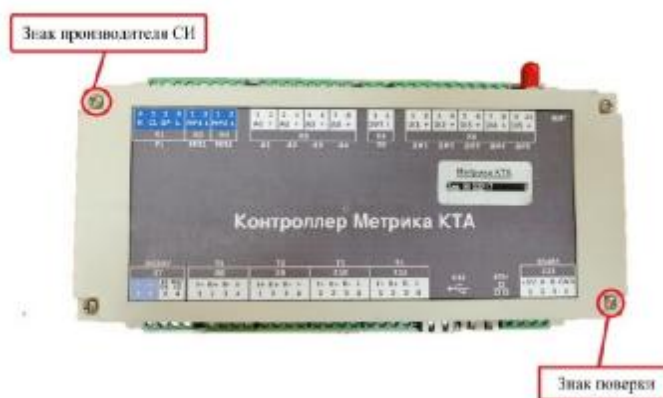
Рисунок 2 – Схема пломбировки контроллеров
