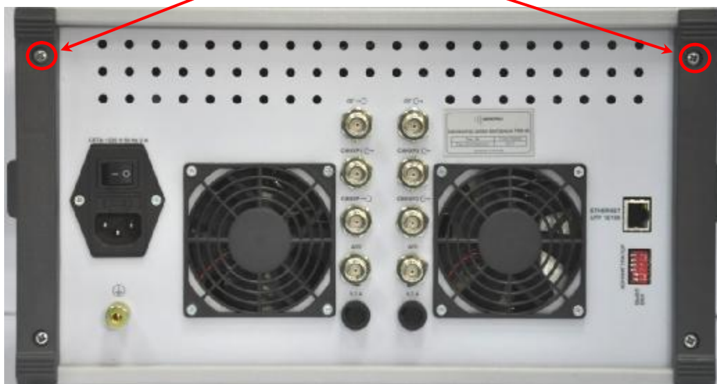
Рисунок 2– Схема пломбировки от несанкционированного доступа
