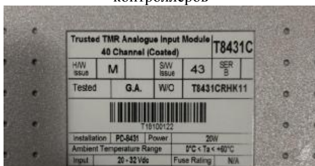
в) модуль ввода Т8431С из состава контроллеров
