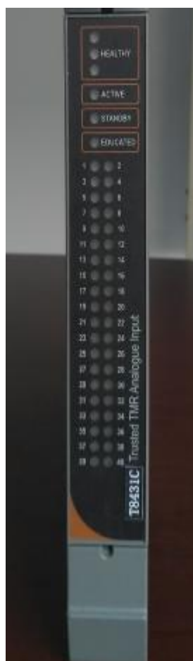
а) модуль ввода Т8431С из состава контроллеров
