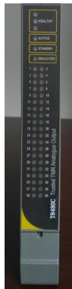
б) модуль вывода Т8480С из состава контроллеров
