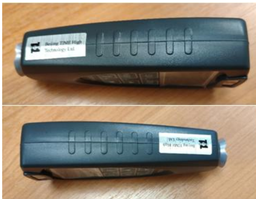
Рисунок 8 – Схема пломбировки от несанкционированного доступа
