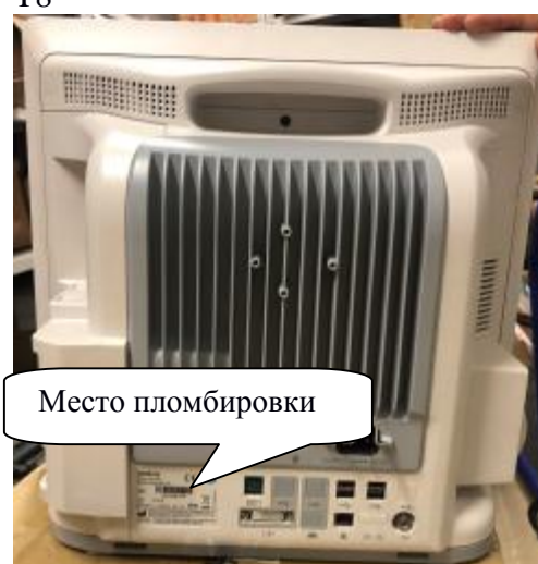
Рисунок 2 – Схема пломбировки от несанкционированного доступа, обозначение места нанесения знака поверки
