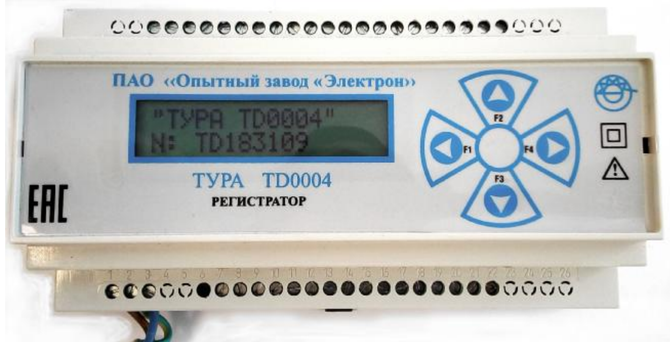
Рисунок 1 – Регистраторы ТУРА-TD0004. Общий вид.
