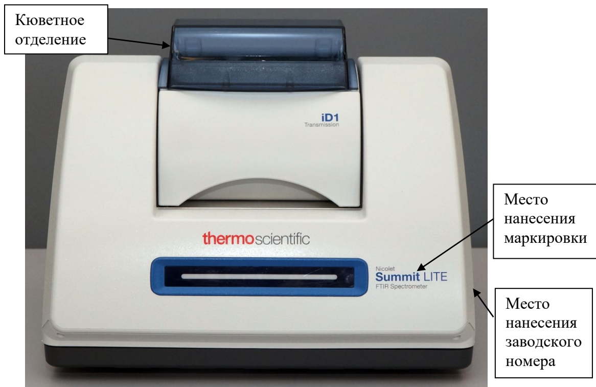
Рисунок 3 - Общий вид спектрометров Nicolet Summit Lite с указанием мест нанесения маркировки, заводского номера
