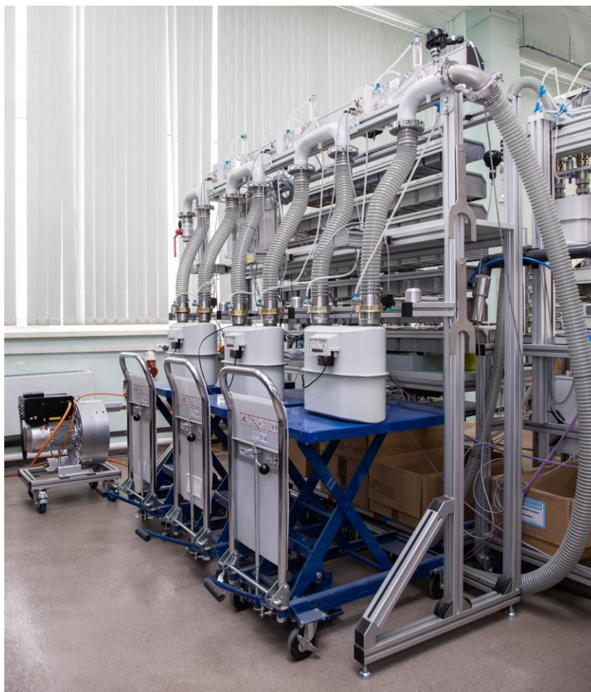
Рисунок 3 –Модуль для проведения поверки (испытаний) счетчиков от G10 до G25
