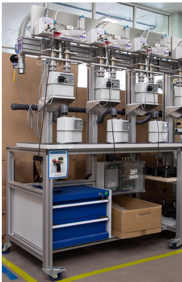
Рисунок 2 –Модуль для проведения поверки (испытаний) счетчиков от G1,6 до G6
