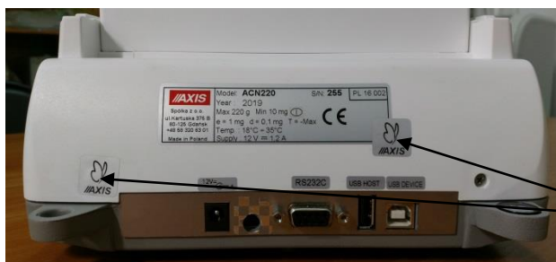
Рисунок 2 – Схема пломбирования от несанкционированного доступа
