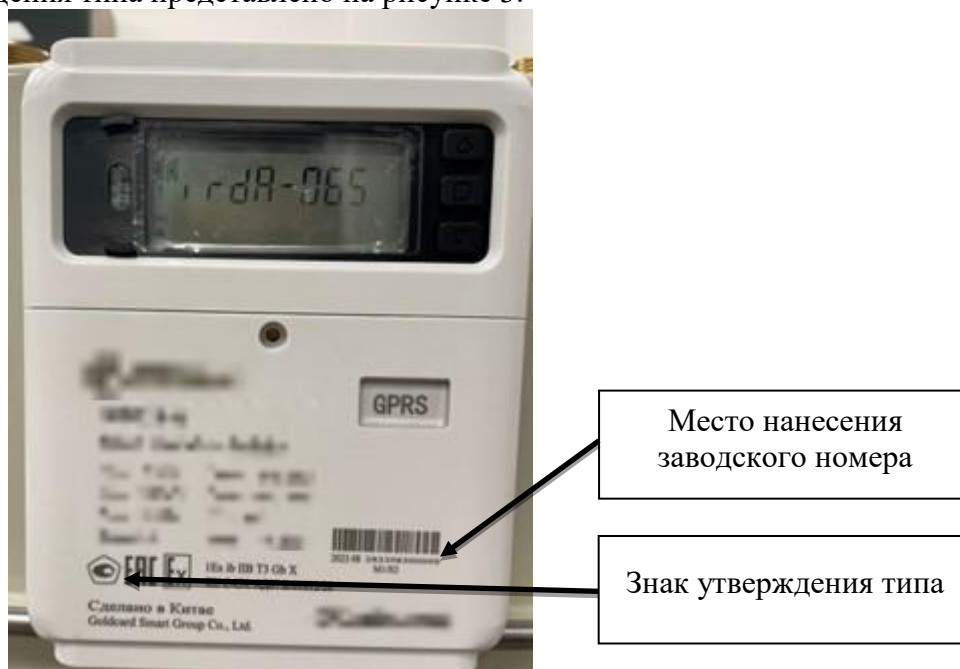
Рисунок 3 – Место нанесения заводского номера и знака утверждения типа
