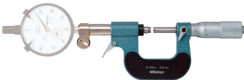
Рисунок 1 – Общий вид микрометров рычажных серии 107 с верхним пределом диапазона измерений до 75 мм
