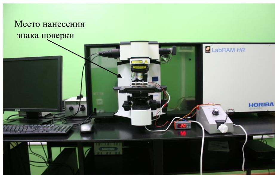
Рисунок 1 – Общий вид задней стенки спектрометра комбинационного рассеяния света HORIBA LabRam HR800 и обозначение места нанесения знака поверки.
