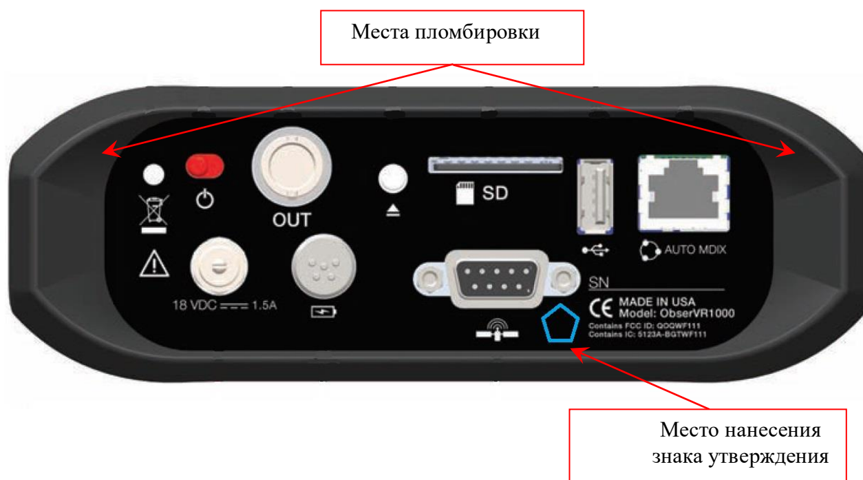
Рисунок 2 – Общий вид задней панели регистраторов и анализаторов данных портативных ObserVR1000 и места пломбирования и нанесения знака утверждения типа
