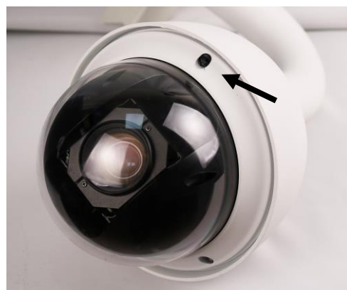
Место пломбировки видеодатчика исп. 2
