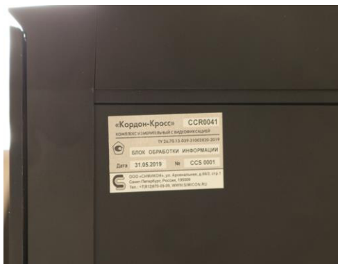
Место нанесения знака утверждения типа и заводского номера
