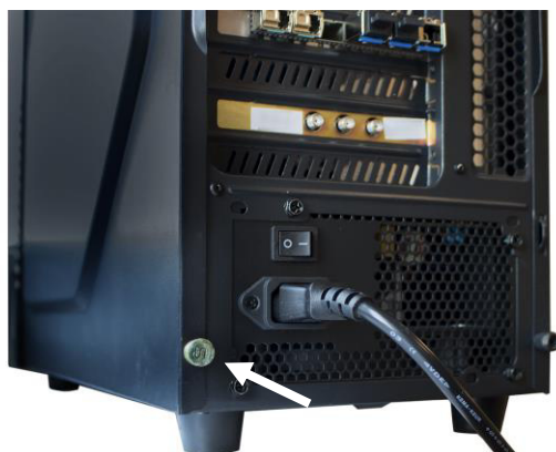
Место пломбировки блока обработки информации
