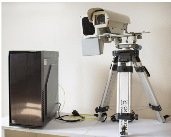
Комплекс «Кордон-Кросс» с видеодатчиком «Кросс»ДР (КР) и прожектором подсветки
