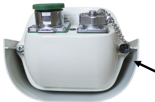
Место пломбировки видеодатчика
