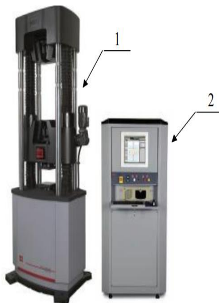
Рисунок 1 – Общий вид машин испытательных универсальных гидравлических MTS Criterion 64 (1 – силовая рама, 2 – интегрированная операционная платформа)
