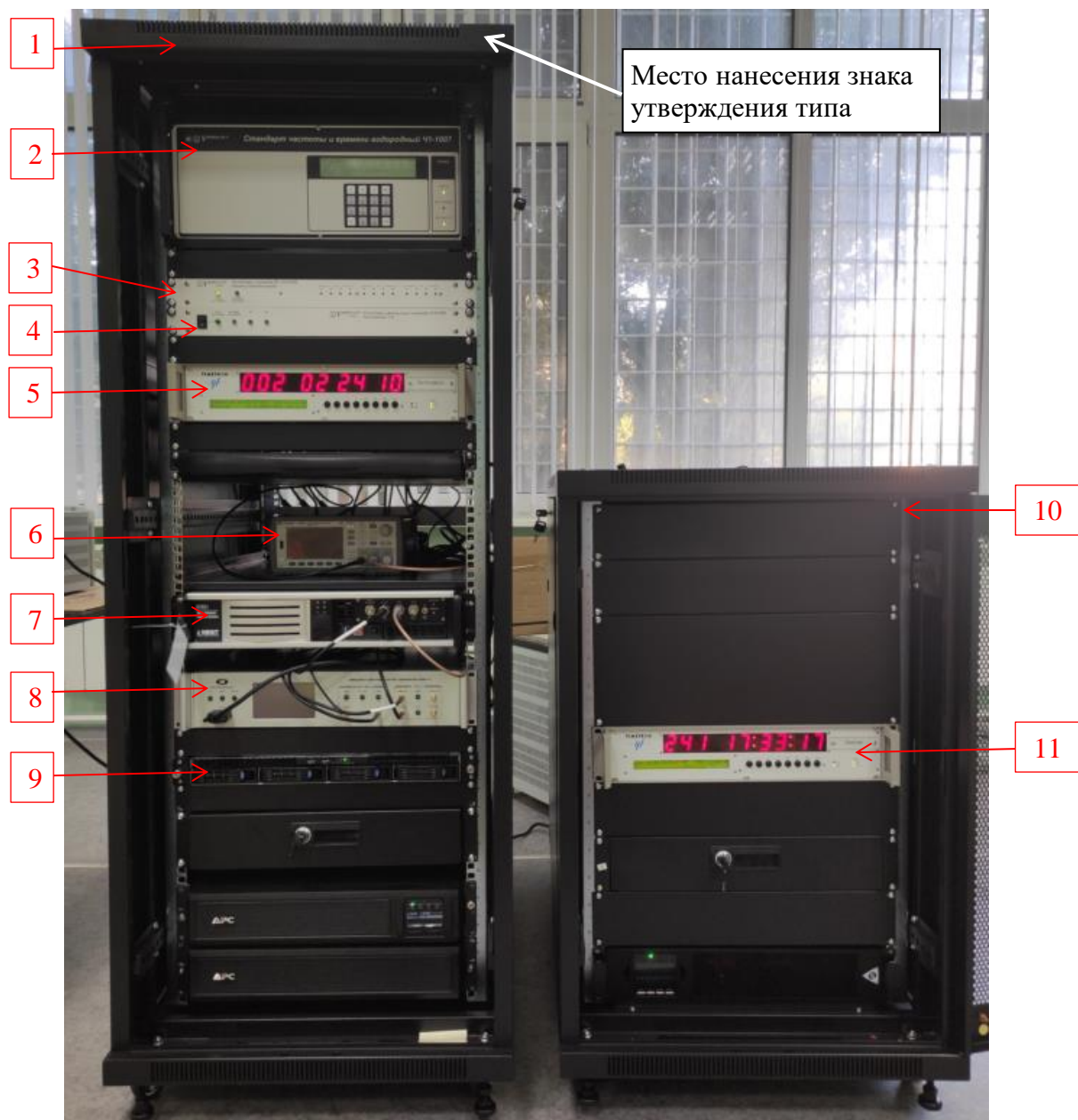
1 - шкаф МГФК.469134.004; 2 - стандарт частоты и времени водородный Ч1-1007; 3 - усилитель сигналов высокой частоты VCH-605; 4 - усилитель импульсных сигналов VCH-606; 5 - оконечное устройство оптоволоконной связи ТИМ-10569; 6 - частотомер 53230А; 7 – аппаратура для высокоточного сравнения шкал времени GTR-51; 8 - генератор смещения фазы и частоты HROG-10RM; 9 – сервер; 10 - шкаф МГФК.469134.005; 11 - источник оптоволоконной связи ТИМ-10568 Рисунок 1 – Общий вид комплекса
