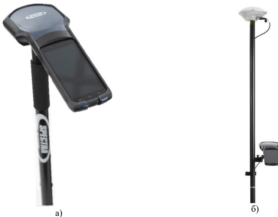
Рисунок 2 – Общий вид аппаратуры, установленной на веху а) с использованием адаптера крепления мини-вехи; б) с использованием кронштейна и внешней антенны ГНСС
