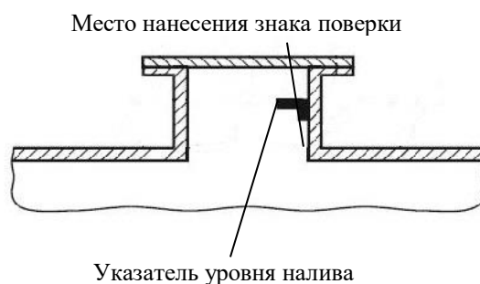
Рисунок 3 – Схема пломбировки от несанкционированного изменения положения уровня налива, обозначение места нанесения знака поверки
