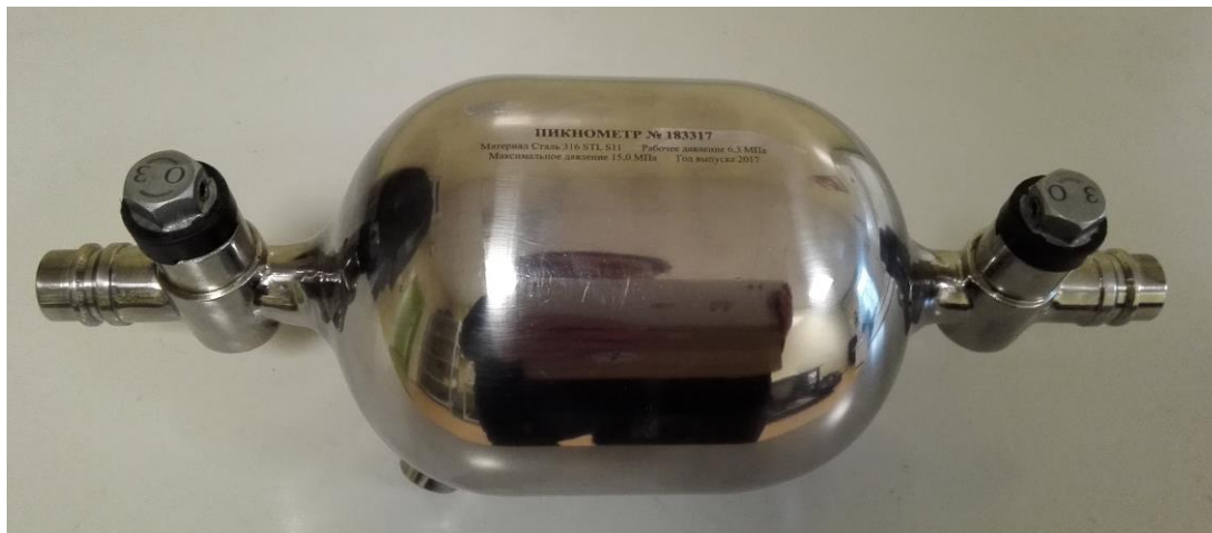
Рисунок 1 – Общий вид пикнометра напорного. Серийный номер пикнометра, год выпуска, марка материала, значения рабочего и максимального давлений рабочей среды нанесены на корпус пикнометра (Рисунок 2)
