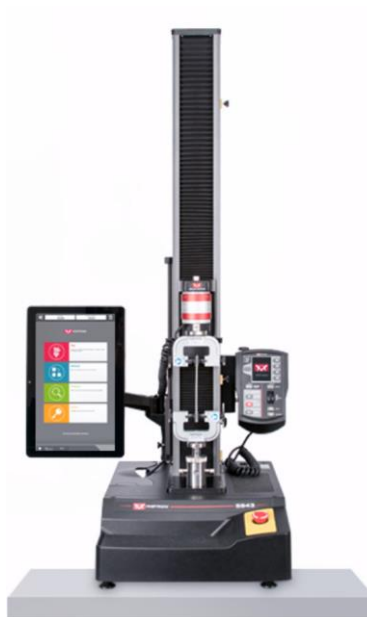
Рисунок 1 – Общий вид машин испытательных электромеханических серии 5900 в одноколонном исполнении
