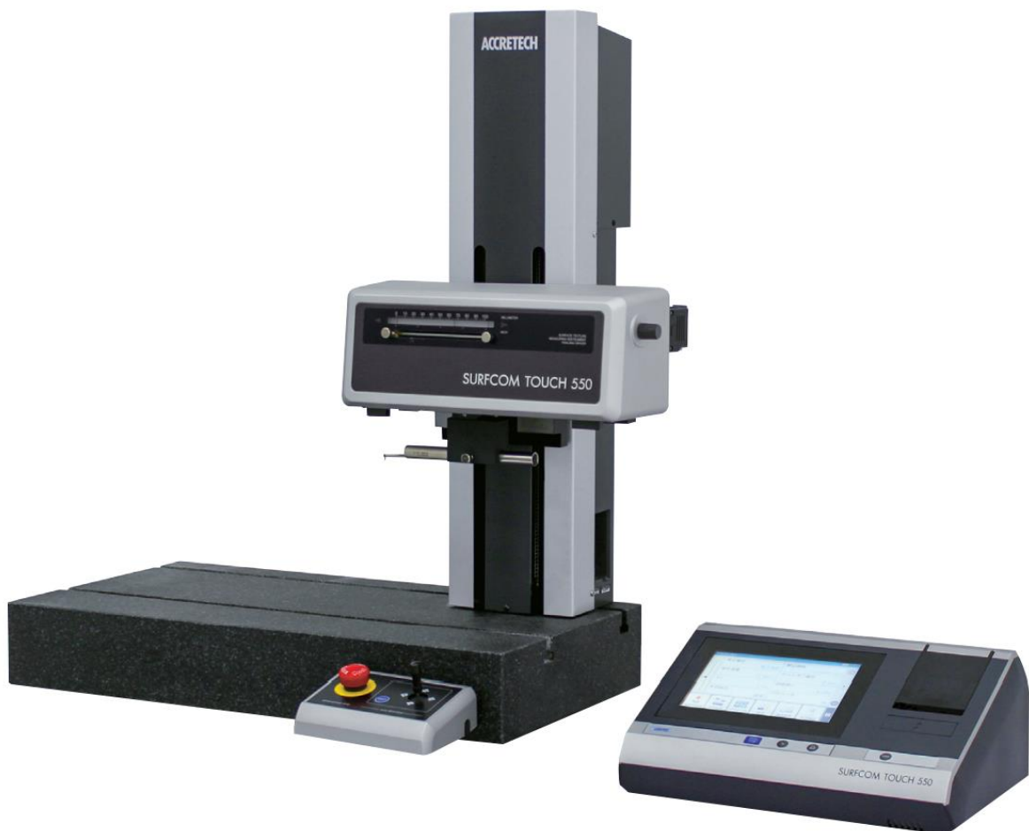
Рисунок 4 – Общий вид приборов для измерений параметров шероховатости поверхности SURFCOM TOUCH модификации SURFCOM TOUCH 550
