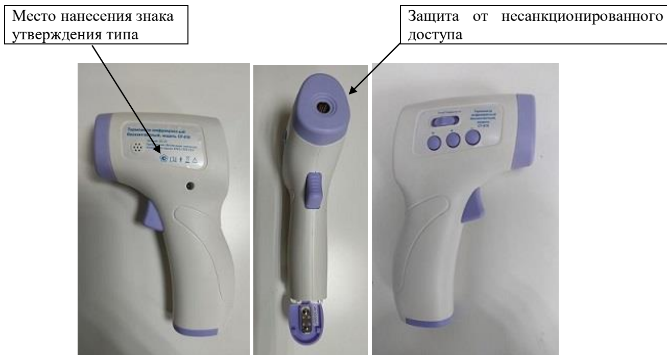
Рисунок 1 - Общий вид и схема пломбировки от несанкционированного доступа термометров инфракрасных бесконтактных модель CF-818
