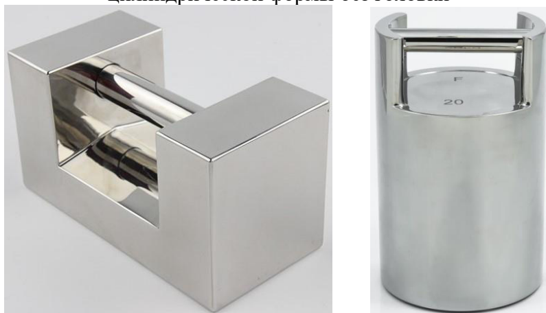
Рисунок 3 – Общий вид гирь из нержавеющей стали с номинальной массой от 5 кг до 20 кг цилиндрической формы с ручкой и параллелепipedной формы с ручкой
