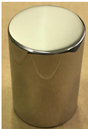
Рисунок 2 – Общий вид гирь из нержавеющей стали с номинальной массой от 1 г до 20 кг цилиндрической формы без головки
