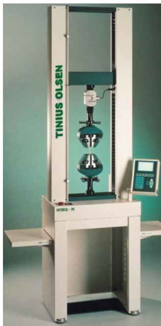
Рисунок 1 – Общий вид машины электромеханической универсальной испытательные TINIUS OLSEN серии HxK-M модификации HxKS-M
