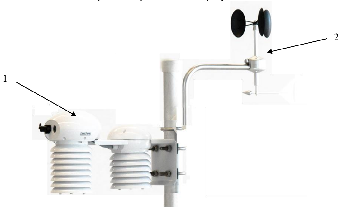
Рисунок 1 — Общий вид датчиков комбинированных погодных g-weather 1 – моноблок, 2 – ПИП скорости и направления воздушного потока
