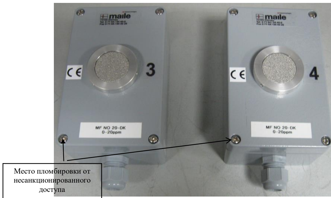
Рисунок 3 – Общий вид датчиков MF NO 20-DK
