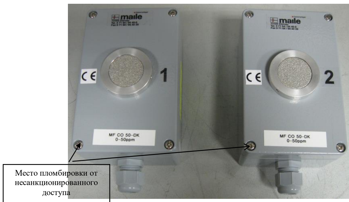
Рисунок 2 – Общий вид датчиков MF CO 50-DK
