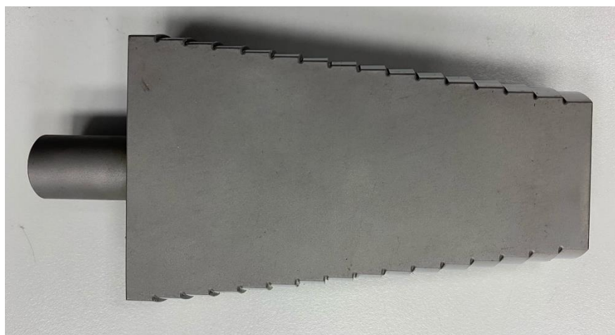
в) Мера диаметром от 50 мм до 80 мм и длиной 128 мм
