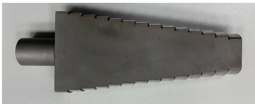
б) Мера диаметром от 26 мм до 52 мм
