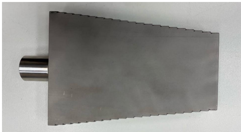
г) Мера диаметром от 80 мм до 120 мм
