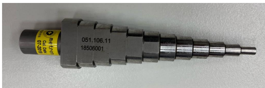
а) Мера диаметром от 4 мм до 26 мм
