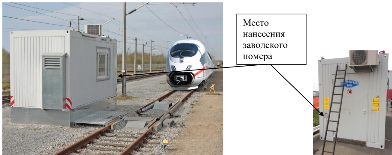
Рисунок 1 – Общий вид комплекса автоматизированного для диагностики колесных пар на ходу Argus2.MM
