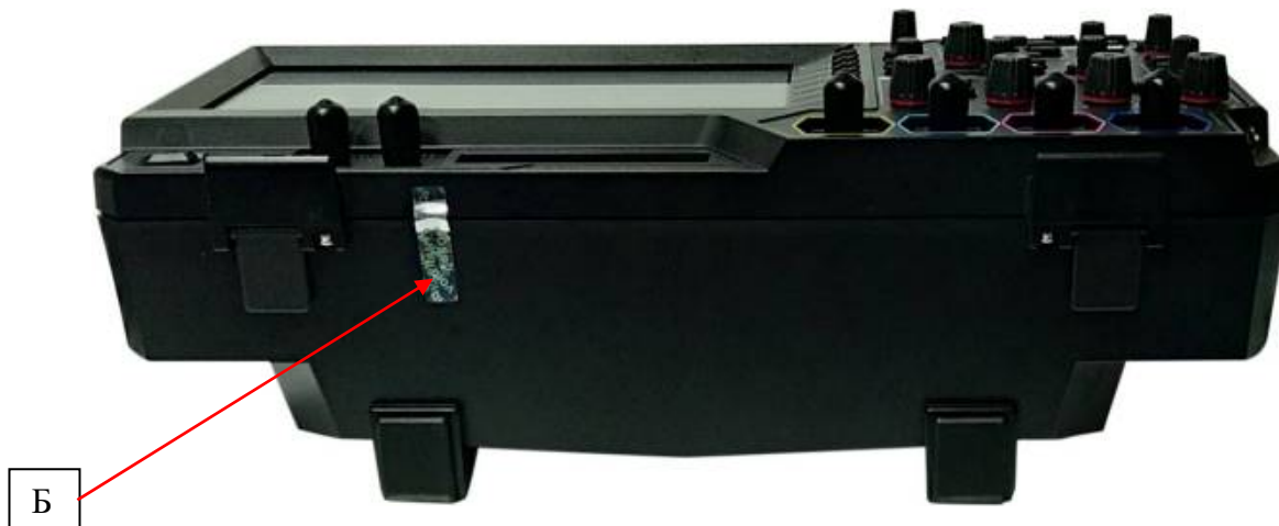
Рисунок 6 – Схема пломбировки от несанкционированного доступа (Б)
