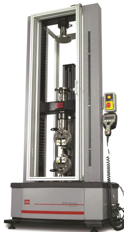
Рисунок 2 – Общий вид машины испытательной универсальной электромеханической MTS Criterion 40 с двумя направляющими колоннами
