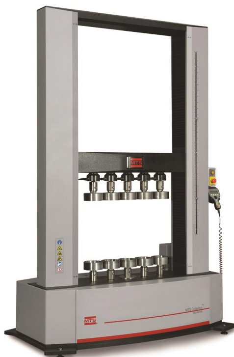
Рисунок 3 – Общий вид машины испытательной универсальной электромеханической MTS Criterion 40 с пятью зонами испытаний
