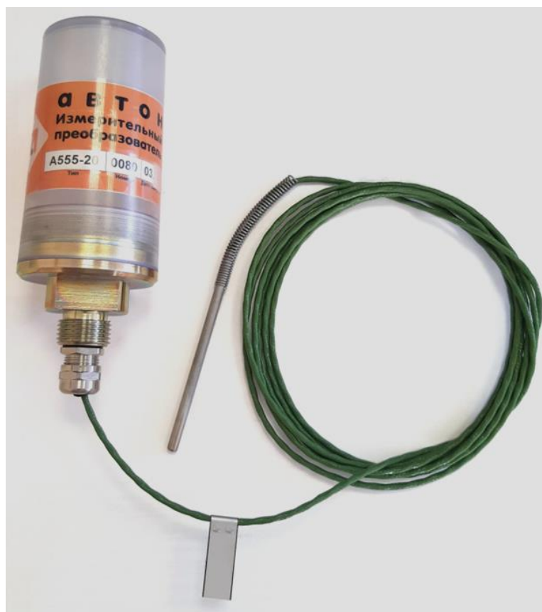
а) исполнение термошупа ТЦ0 (в виде цилиндрической гильзы)
