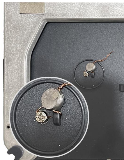
Рисунок 3 – схема пломбировки весов от несанкционированного доступа весов с индексами варианта исполнения С (используется свинцовая пломба)
