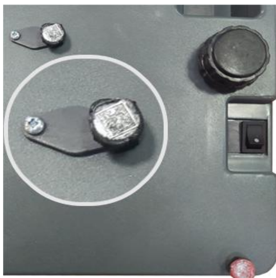
Рисунок 2 – схема пломбировки весов от несанкционированного доступа весов с индексами варианта исполнения А и В (используется пластилиновая пломба)
