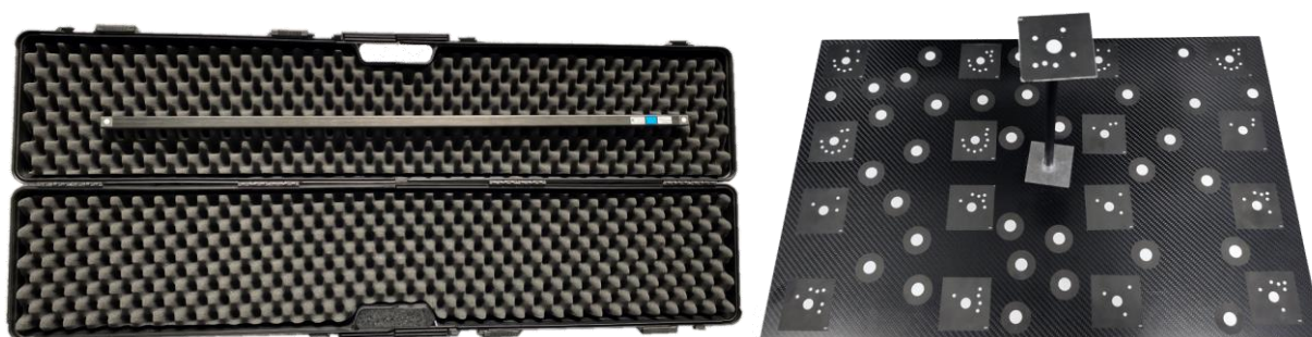
Рисунок 2 – Общий вид мер, слева специальная мера в кейсе, справа – калибровочная мера для видеокамер
