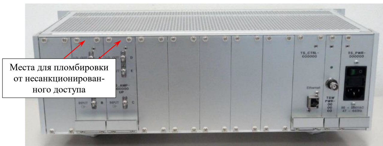
Рисунок 2 – Задняя панель основного блока с указанием мест пломбировки от несанкционированного доступа
