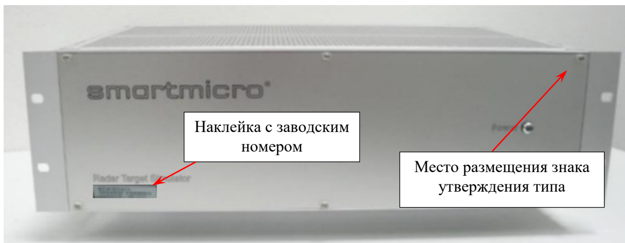
Рисунок 1 – Передняя панель основного блока с указанием места размещения знака утверждения типа и заводского номера
