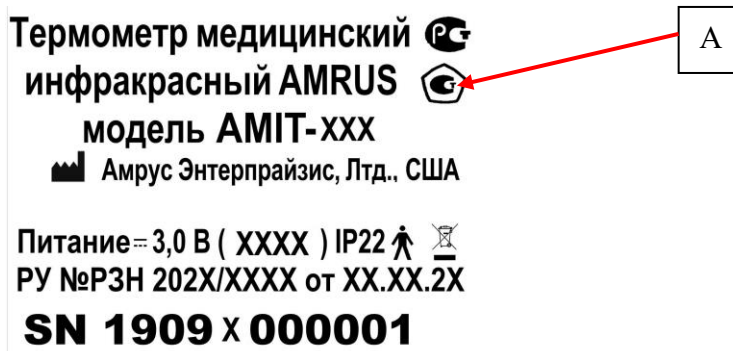
Рисунок 2 – Место нанесения знака утверждения типа (А)
