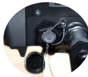
Рисунок 4 – Схема пломбировки приборов ТИТАН, обозначение мест нанесения знака поверки
