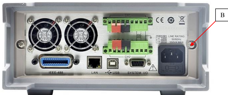
Рисунок 3 – Вид задней панели источников, место пломбировки от несанкционированного доступа (B)
