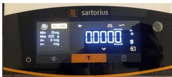
Рисунок 2 – Общий вид модуля терминала VCE с элементами оранжевого цвета
