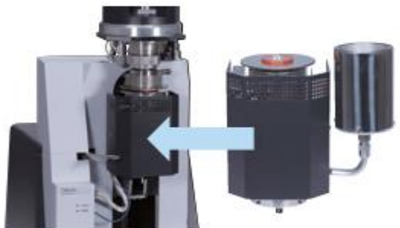
Рисунок 2 – Внешний вид низкотемпературного блока печи LTB-60
