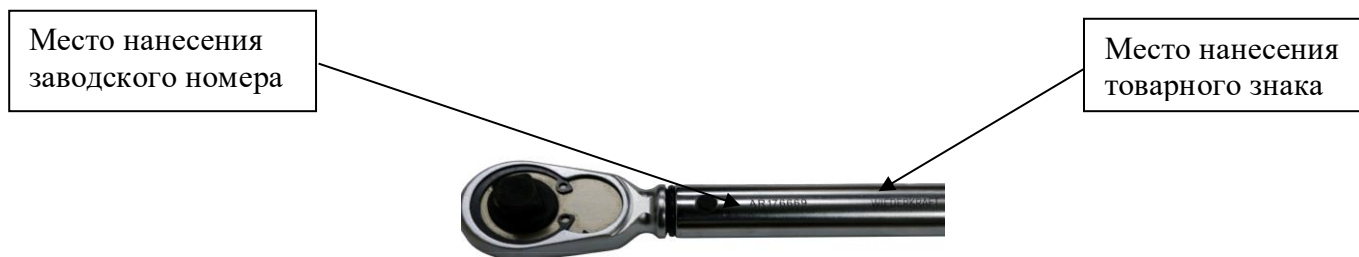
Рисунок 9 – Пример типовой маркировки ключей с нанесением заводского номера и товарного знака
