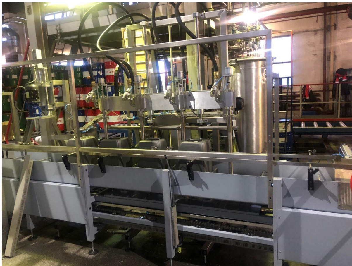
Рисунок 1 – Общий вид дозатора весового дискретного действия ЛФМ 21-50
